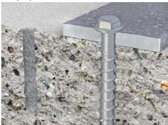
As cargas aplicadas são transferidas para o substrato por meio de uma zona contínua de interferência. Caracteriza-se pela ação de um parafuso auto atarraxante no material base, sua rosca em contato com a parede do furo lamina o material base, distribuindo a carga por toda a expansão do parafuso chumbador.
