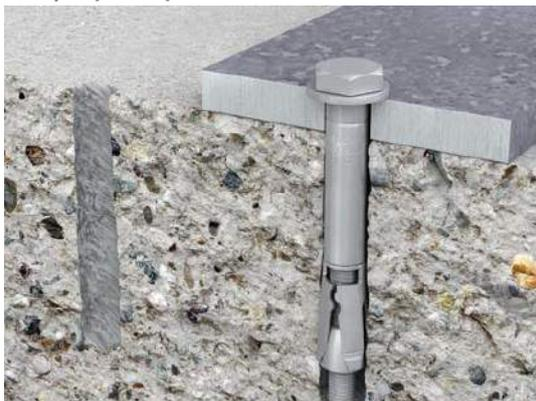
As cargas aplicadas são transferidas para o substrato por meio de atrito entre o chumbador e a parede do furo. O atrito é o resultado da força de expansão, obtida por aplicação de um torque no parafuso ou porca, que faz uma camada externa se abrir aumentando o diâmetro do chumbador, fixando-o no furo onde o mesmo foi colocado.
