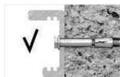
Retire o parafuso e arruela. Posicione a peça a fixar, recoloque o parafuso e arruela dando o devido aperto
