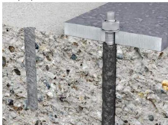
As cargas aplicadas são transferidas para o substrato por meio de adesão da barra rosca ou vergalhão ao furo, através de compostos químicos. Este tipo de ligação é indicada para substratos maciços densos, mas também pode ser utilizada em bases leves e ocas, com auxílio de camisa de injeção.
