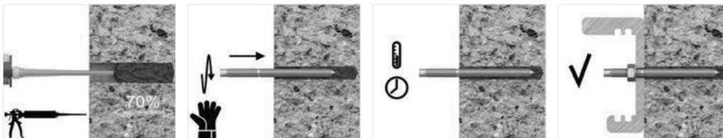
Aplique a resina no furo. Preencha aprox. 2/3 do furo, do fundo para superfície. Introduza a haste roscada girando-a
