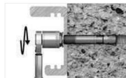
Aperte a porca provocando a expansão concluindo a fixação
