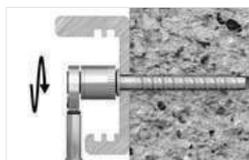
Posicione a peça a fixar e aplique o parafuso concluindo a fixação.
