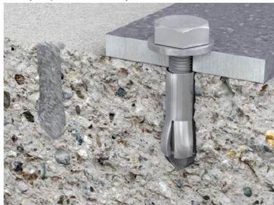
As cargas aplicadas são transferidas para o substrato por meio de fricção entre o chumbador e a parede do furo. O atrito é o resultado da força de expansão, que faz uma camada externa se deformar, aumentando o diâmetro do chumbador, fixando-o no furo onde o mesmo foi colocado.
