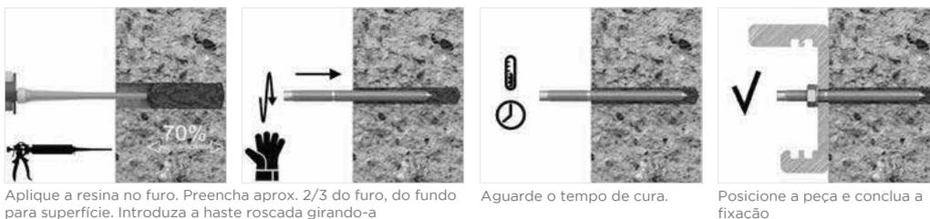
Aplique a resina no furo. Preencha aprox. 2/3 do furo, do fundo para superfície. Introduza a haste roscada girando-a
